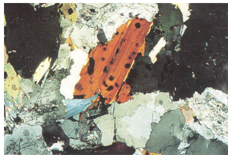
Figura 16– Aspecto microscópico de rocha composta por Quartzo, Feldspato potássico, Plagioclásio, Biotita, Muscovita e Zircão ampliação 25 X. Fonte: MOURA, A. C. 2000.p.20.
